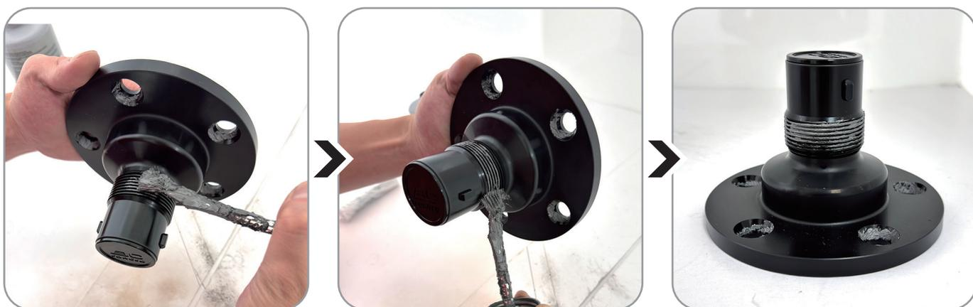
**STEP.3** 在BC單孔大螺帽外緣，塗抹適量的防卡潤滑劑。
