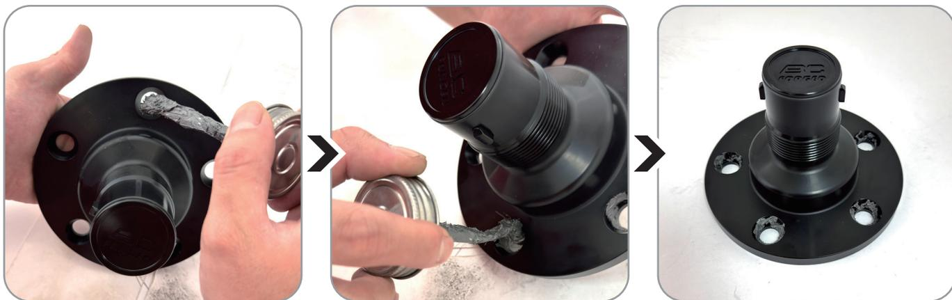
**STEP.2** 在BC單孔座螺牙上，塗抹適量的防卡潤滑劑。
